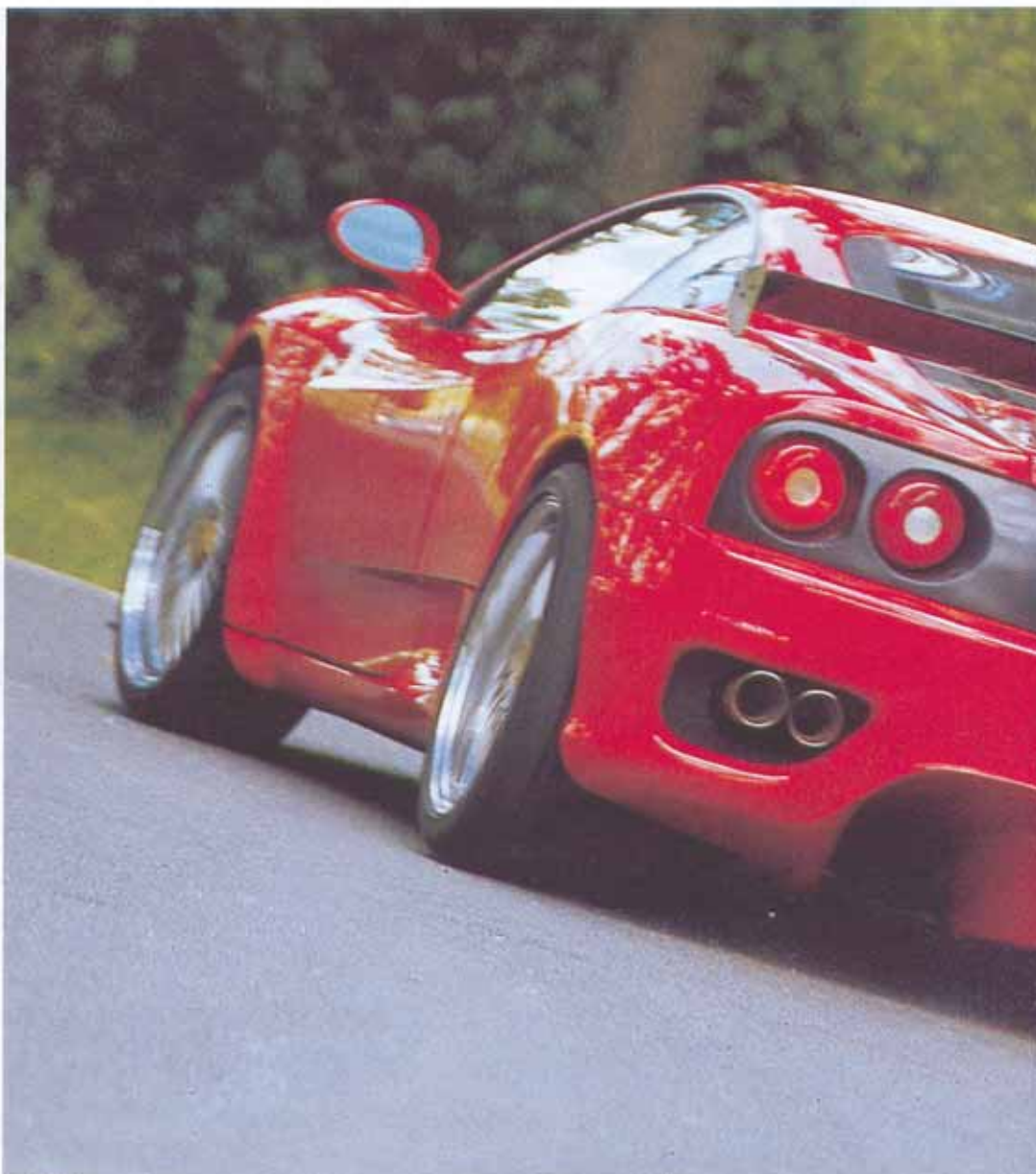
Der Heckflügel (oben) stammt von LC, ebenso der Auspuff. Vorderachse und Body sind acht Zentimeter breiter, hinten bringen breitere Räder die Leistung auf die Straße. In Nardo soll der 440 PS starke LC-Modena (zehn Prozent Mehrleistung) 314 km/h erreicht haben. Unten: Feinarbeit im Innenraum. Rechts: Ferrari-typisch: der kleine Rückwärtsgang-Hebel auf der Mittelkonsole
